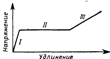
Рис. 17. Зависимость удлинения от силы для кристаллического линейного полимера.
