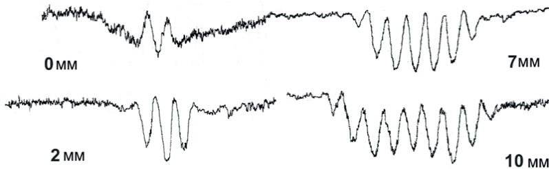
Рис. 4.20. Микрофотограммы решеток при различном положении предметного столика на оптической оси установки (период решетки около 30 мкм)
