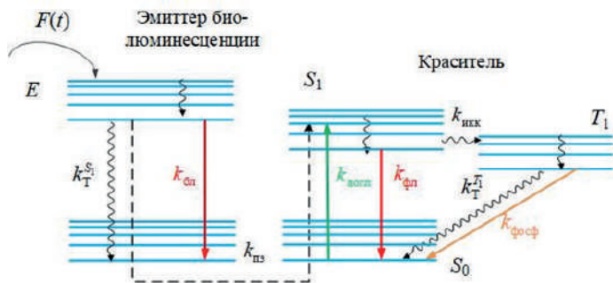
Рис. 5.1. Диаграмма уровней энергии донорно-акцепторной пары, состоящей из биолюминесцентного излучателя и красителя
