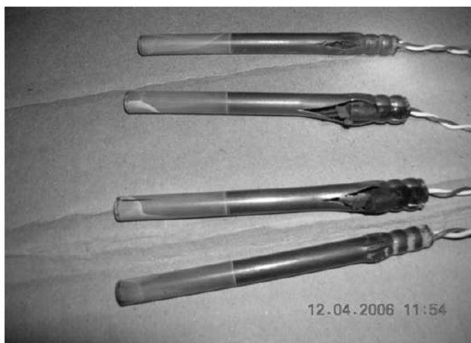
Рис. 9.10. Разрушение гильзы давлением продуктов горения замедляющего состава в зоне маркировки
