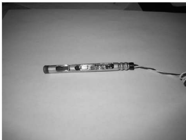
Рис. 9.6. Детонатор со встроенным сверхминиатюрным «интеллектуальным» микроконтроллером
