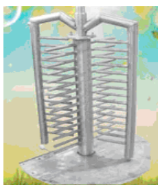
Рис. 8.17. Варианты мешалок для реакторов: а – пропеллерная с перфорацией; б – рамно-решетчатая; в – рамно-якорная с перфорацией; г – якорная
