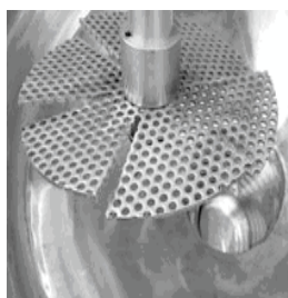
Рис. 8.17. Варианты мешалок для реакторов: а – пропеллерная с перфорацией; б – рамно-решетчатая; в – рамно-якорная с перфорацией; г – якорная
