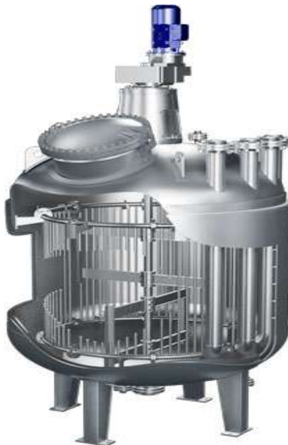
Рис. 8.16. Опытно-промышленный 1 м 3 реактор из нержавеющей стали
