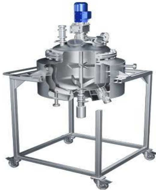
Рис. 8.15. Лабораторный 10 л химический реактор из нержавеющей стали. Расположение перемешивающего устройства – вертикальное; установленная мощность 3,0–45 кВт; скорость вращения мешалки, 0–18000 об/мин; основной материал сталь 12Х18Н10Т или AISI 316; рабочее давление пара в рубашке 0,2–0,4 МПа; рабочее разрежение пара в корпусе аппарата – до 0,03 МПа
