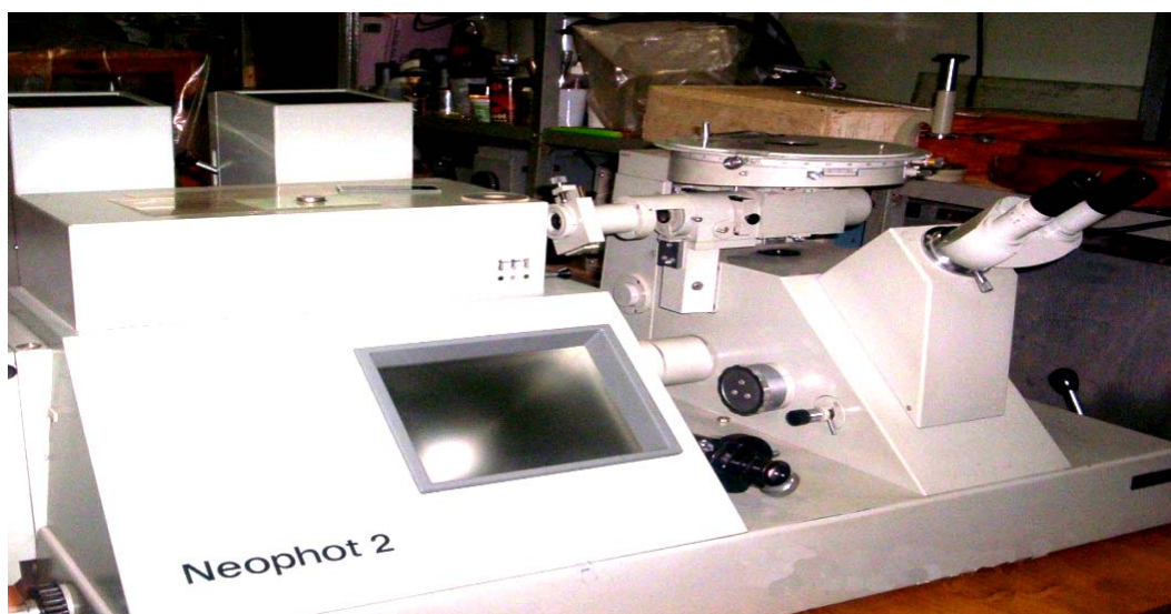
Рис. 8. Конструкция микроскопа Neophot-2 (разрешение 0,3 мкм)
