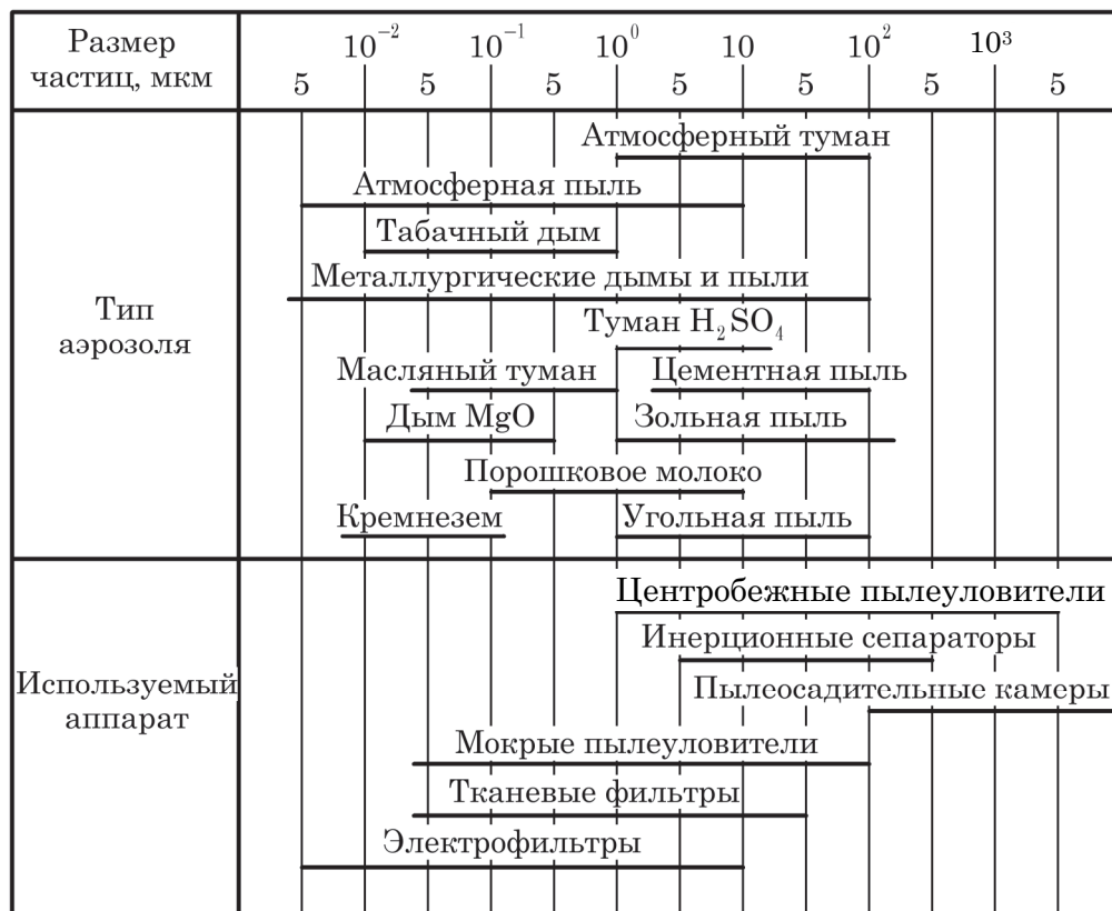
Рис. 7.27. Размеры частиц, которые можно уловить различными аппаратами
