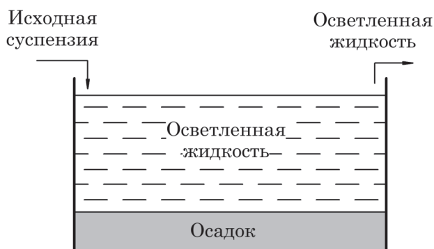
Рис. 2.10. Схема полунепрерывного отстойника
