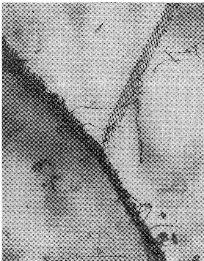
Рис. 114. Линии дислокации в кристалле молибдена. Снято в электронном микроскопе.
