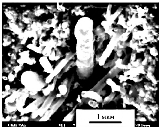
Рис. 11.7. СЭМ изображение агломерата углеродных нановолокон в матрице ZrO_2 . Адаптировано из [11.24]
