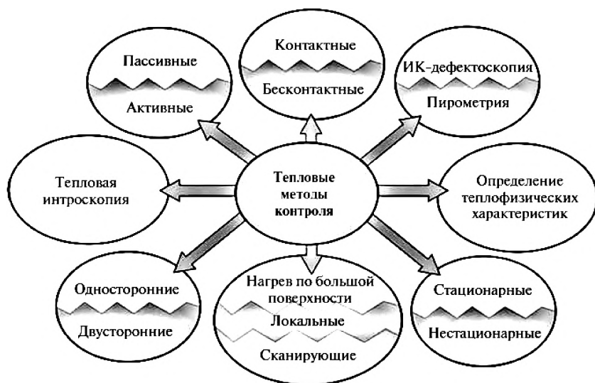
Рис. 7.6. Классификация основных методов теплового контроля
