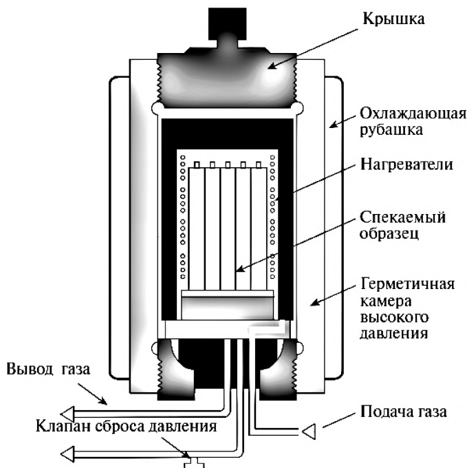
Рис. 5.5. Схема установки для горячего изостатического прессования. Адаптировано из [5.3]
