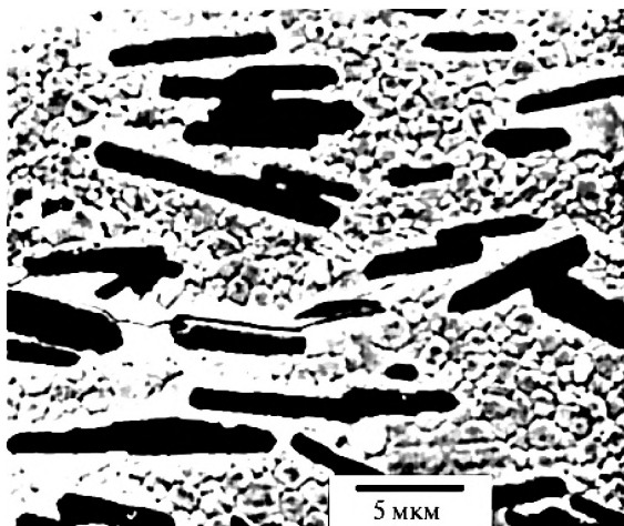
Рис. 11.1. Отражение трещины от пластинок Al_2O_3 в композите ZrO_2-Al_2O_3 . Адаптировано из [11.1]
