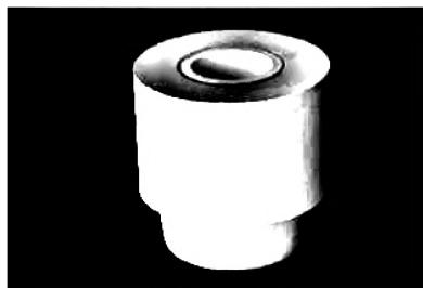
Рис. 3.5. Композитный стакан-дозатор, состоящий из двух сортов керамики на основе ZrO_2
