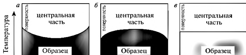
Рис. 6.9. Температурные профили образцов при традиционном (а), микроволновом (б) и гибридном (в) спекании. Адаптировано из [6.13]
