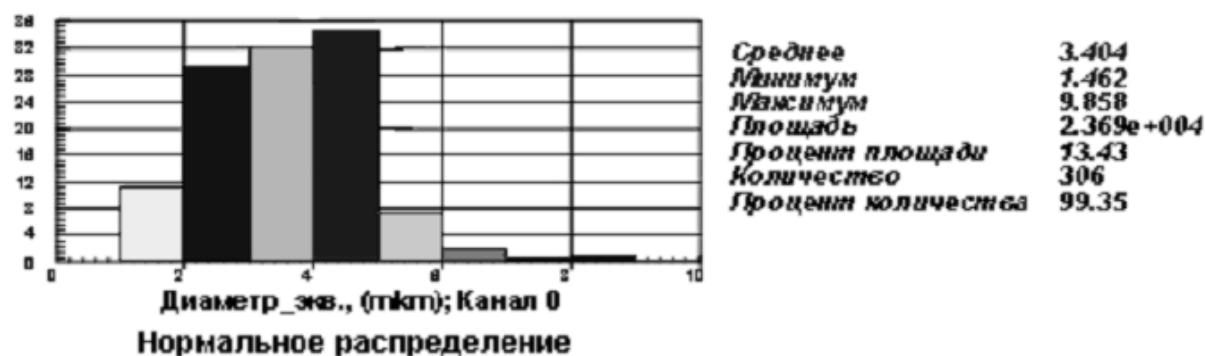
Рис. 35. Распределение частиц интерполимерных ПАК-ПВС по размерам. Реакционная среда глицерин (20)–вода(80)
