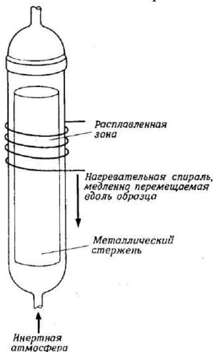
Рис. 32. Очистка металла зонной плавкой
