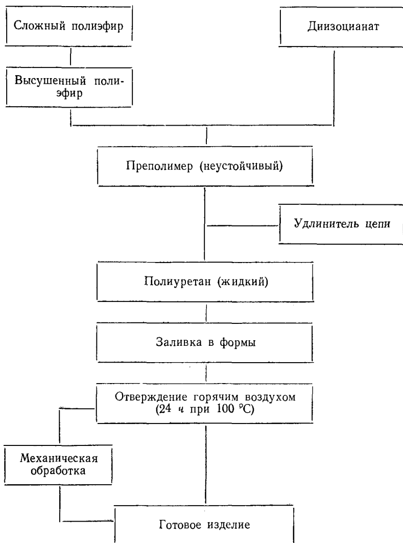
Схема 1. Производство литьевого вулколлана
