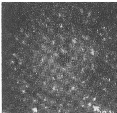
Рис. 16а. Диаграмма дифракции медленных электронов от грани Ni (100) после ее обработки соединением серы
