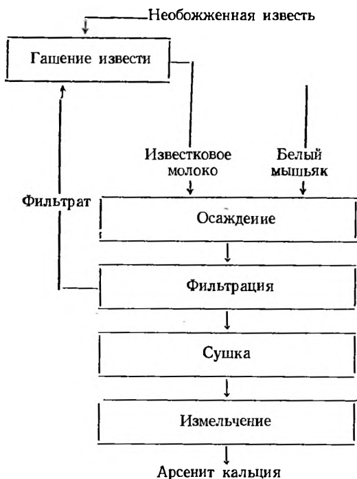
Рис. 12.8. Схема основных производственных стадий получения арсенита кальция из растворов.
