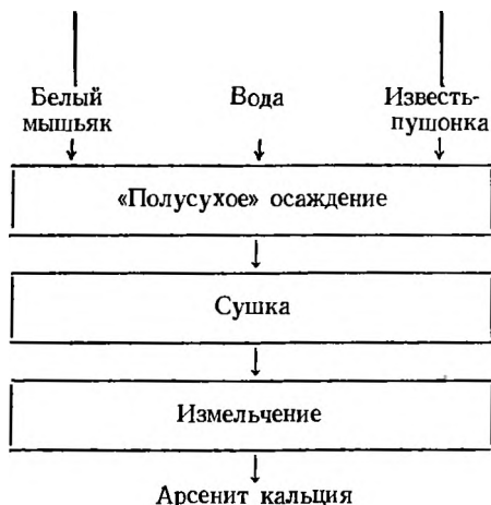
Рис. 12.10. Схема основных производственных стадий получения арсенита кальция «полусухим» методом.
