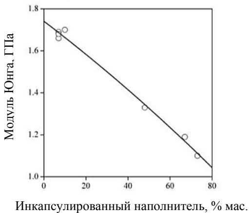
Рис. 7. Зависимость жесткости трехкомпонентных композиций ПП от степени инкапсуляции наполнителя эластомером
