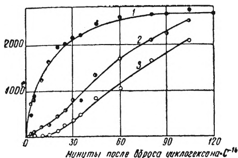
Рис. 64. Кривые изменения удельных молярных активностей после введения в окисляющийся циклогексан добавки радиоактивного циклогексана ( 140^\circ , стальной реактор):
