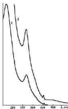
Рис.2. УФ спектр метанофуллерена 17 . Условия: 1-концентрация 3 \cdot 10^{-4} М в \text{CHCl}_3 , 2-концентрация 9 \cdot 10^{-4} М в \text{CHCl}_3 .
