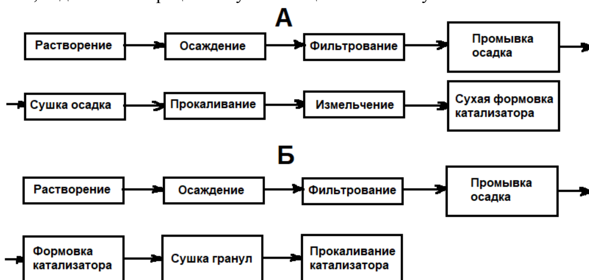
Рис. 3.5. Приготовление катализаторов при сухом (А) и влажном (Б) способах формовки
