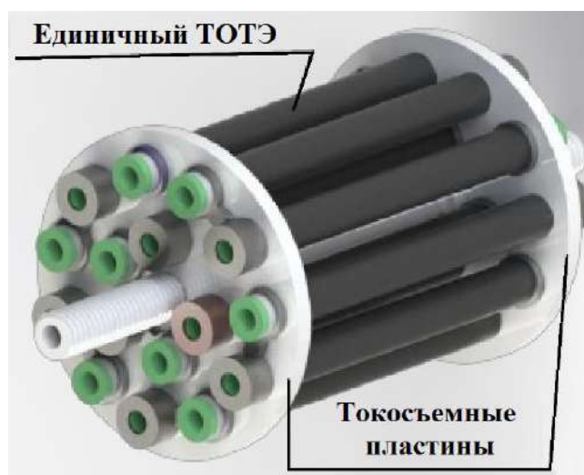
Рис. 3. Трубчатое исполнение ТОТЭ.
