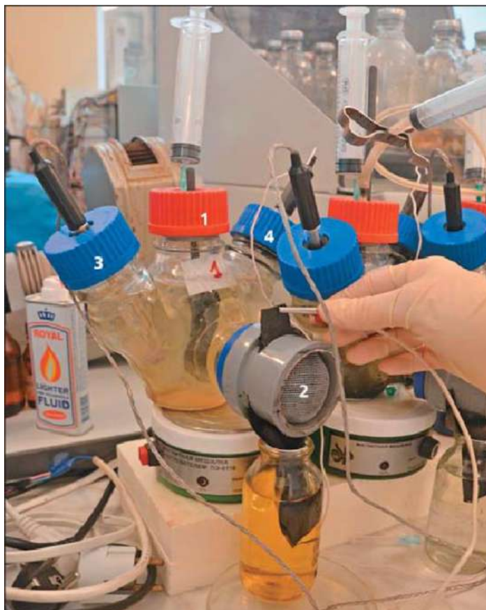
Рис. 26. Лабораторный прототип микробного топливного элемента для скрининга и культивирования сообществ и чистых культур электрогенных микроорганизмов: 1 — анод, 2 — катодная камера, 3 — рН-электрод, 4 — электрод сравнения.
