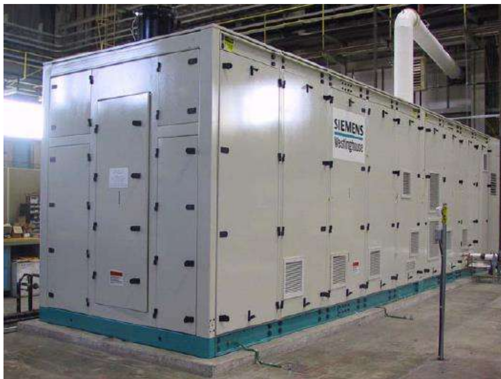
Рис. 9. Внешний вид ЭЭУ фирмы Siemens Westinghouse мощностью 250 кВт.
