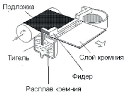
Рис.4.4. Принципиальная схема способа ДФЭ (двух формообразующих элементов).
