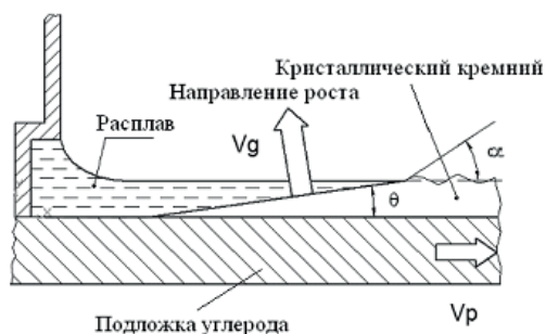
Рис.4.7. Условная схема формирования кристаллического слоя кремния при выращивании по способу ДФЭ.
