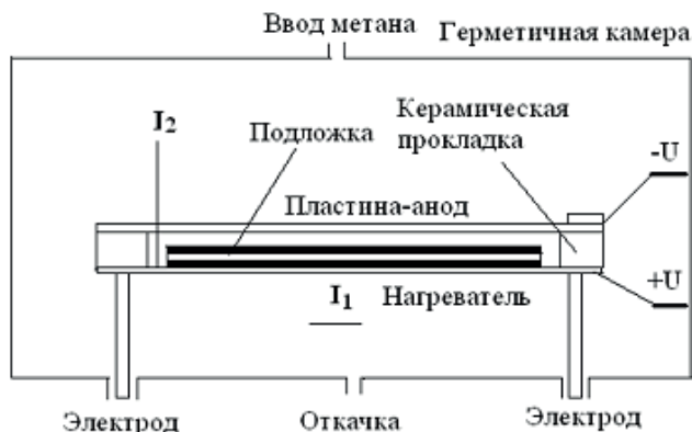
Рис.6.5. Принципиальная схема высокотемпературного процесса получения нанокристаллического углерода при термическом разложении метана в электрическом поле.
