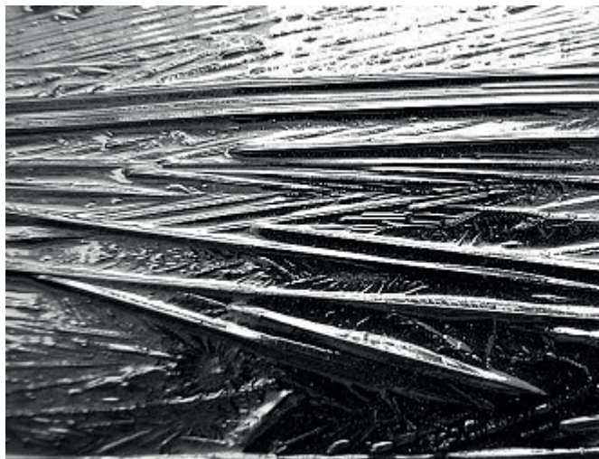
Рис. 4.11. При превышении скорости 9 см/мин процесс переходит в стадию дендритной кристаллизации.
