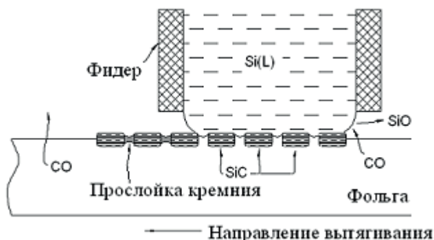
Рис.5.2. Схема, поясняющая причины возникновения кристаллов карбида кремния в рассматриваемом процессе.
