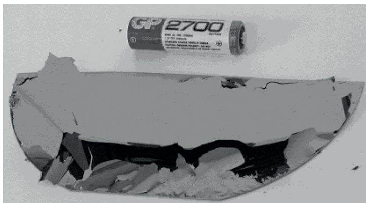
Рис.6.6. Внешний вид пленки нанокристаллического углерода. Значительная разница КТР материалов слоя углерода и подложки кремния приводит к отделению слоя при охлаждении структуры.
