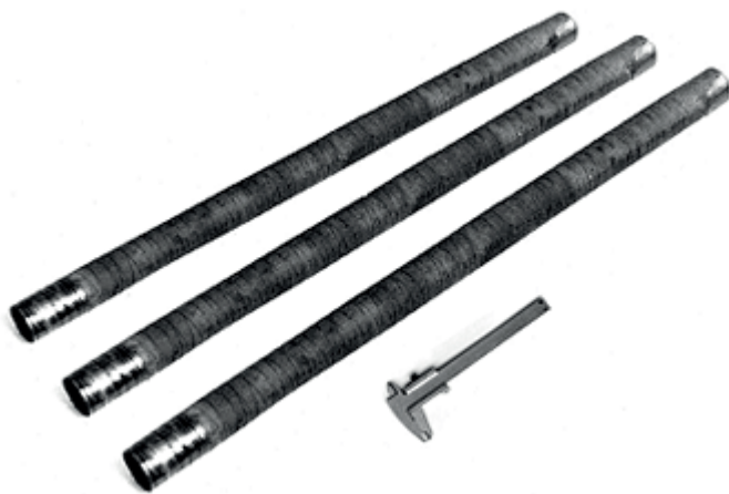
Рис. 2.3. Внешний вид полых нагревателей на основе силицированных УВМ.
