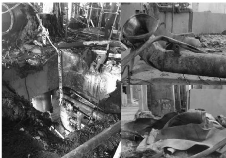
Рис. 6.1.2 Обломки после взрыва выпарного аппарата
