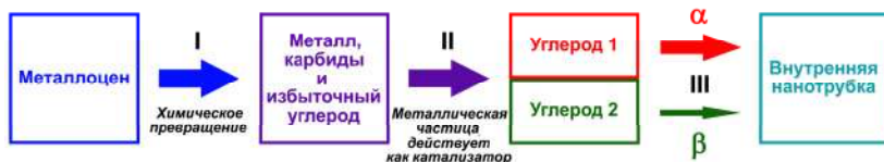
Рис. 3.20. Иллюстрация модели роста внутренних нанотрубок в металлоцен-содержащих ОСНТ. Термическая обработка заполненных ОСНТ приводит к химическому превращению металлоцена с образованием металла, карбидов металла и избытка углерода (этап I). Металлические частицы действуют как катализатор роста внутренних трубок (этап II). Вначале одна часть углерода (1) быстро преобразуется в нанотрубку со скоростью \alpha . Другая часть углерода (2) преобразуется более медленно со скоростью \beta (этап III)
