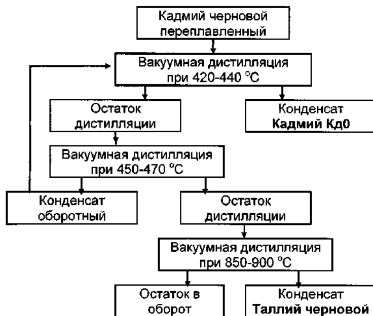
Рис. 4.7. Схема переработки чернового переплавленного кадмия с высоким содержанием таллия вакуумной дистилляцией
