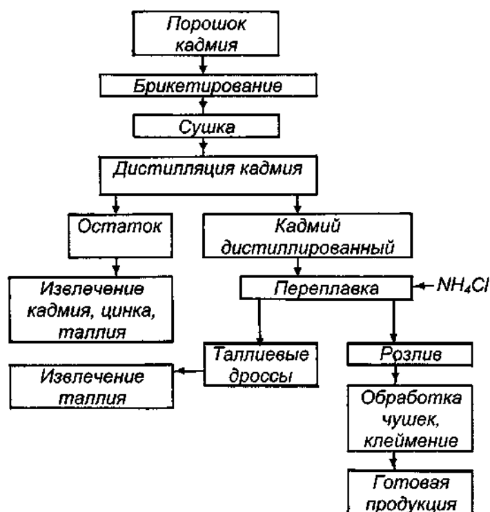
Рис. 4.2. Существующая схема рафинирования кадмия
