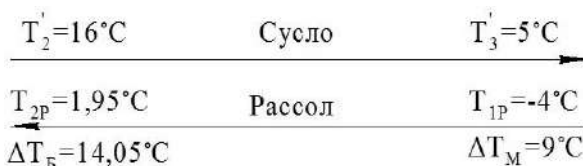
Рис. 1.3. Схема движения теплоносителей в секции рассольного охлаждения
