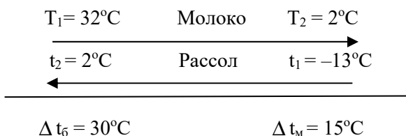
Рис. 1.2. К определению средней разности температур
