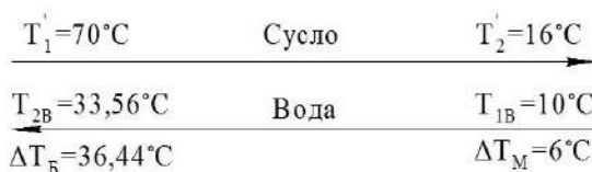
Рис. 1.2. Схема движения теплоносителей в секции водного охлаждения
