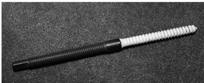
Рис. 5.3. Имплантат с покрытием, нанесенным по шликерной технологии
