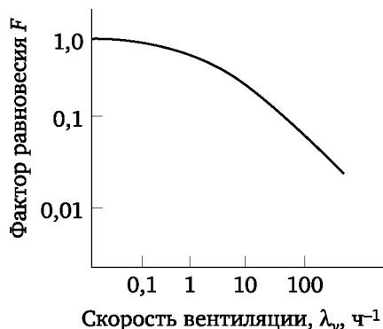
Рис. 23. Зависимость фактора равновесия F от скорости вентиляции в помещении
