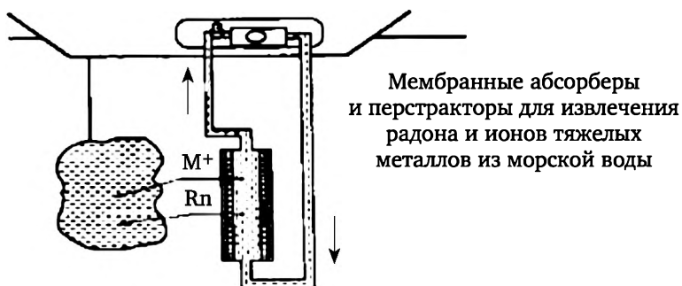
Рис. 11. Мембранно-экстракционные системы для селективного извлечения радионуклидов из морской воды
