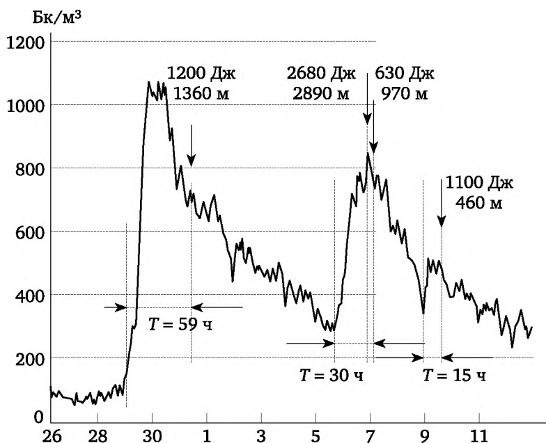
Рис. 15. Поведение объемной активности радона перед горным ударом на больших расстояниях от будущего эпицентра на руднике
