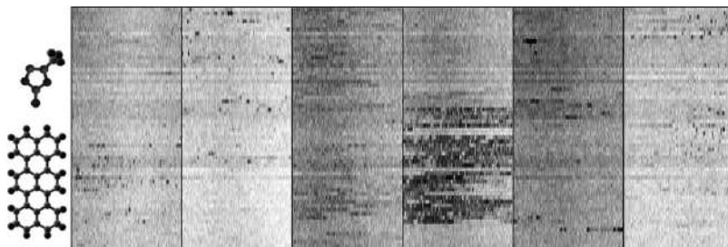
Рис. 5.16. Примеры спектральных траекторий для одиночных молекул терфилена в пропилен-карбонате. T = 4,5 К, диапазон сканирования составляет 30 ГГц, число спектральных точек на скан – 1000, время на одну спектральную точку – 30 мс, количество сканов в спектральных траекториях – 100
