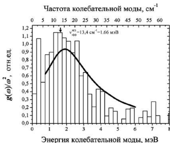
Рис. 6.12. Энергетический спектр НЧМ в аморфном ПИБе (420 000 г/моль), допированном молекулами ТБТ, измеренный методом СОМ (гистограмма), и бозонный пик в чистом ПИБе, измеренный методом неупругого нейтронного рассеяния (сплошная линия) [51]. Для выделения вклада возбуждений, приводящих к возрастанию ПКС над дебаевским спектром, распределения приведены в виде зависимости g(\omega)/\omega^2 от частоты \omega , где g(\omega) – ПКС. Данные по СОМ нормированы на Бозе фактор в соответствии с температурным диапазоном измерений. Стрелкой отмечена эффективная частота НЧМ, измеренная методом ФЭ
