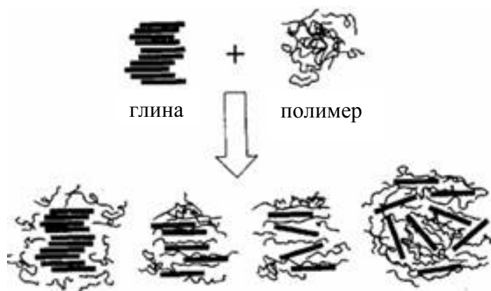
Рис. 12. Схема образования полимерного НК
