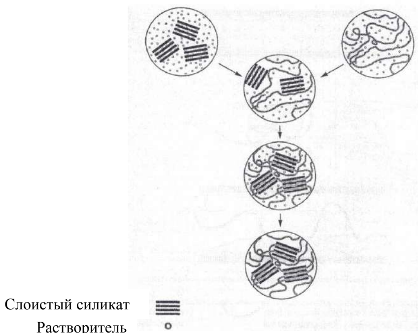
Рис. 10. Схематическое представление НК на основе полимер-слоистых силикатов, полученного интеркаляцией из раствора полимера
