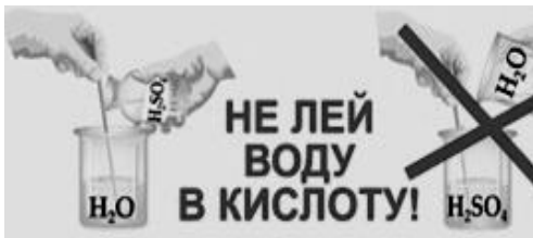
Рис. 21. Приготовление раствора серной кислоты
