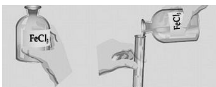
Рис. 12. Положение склянки с реактивом в руке при отборе пробы
