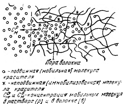
Рис. 2. Схема иммобилизационной диффузии активных красителей в волокно
