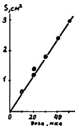
Рис. 4.20. Калибровочная зависимость площади пика уксусной кислоты от дозы. Условия те же, что на рис. 4.19, концентрация 10^{-4}\% (об.)
