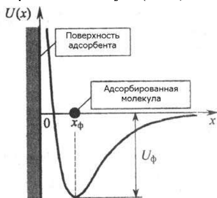
Рис. 2.2. Энергетическая диаграмма для процесса физической адсорбции на поверхности твердого тела
