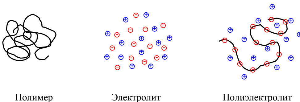
Рис. 5.1.1. Графическое представление молекулы полиэлектролита
