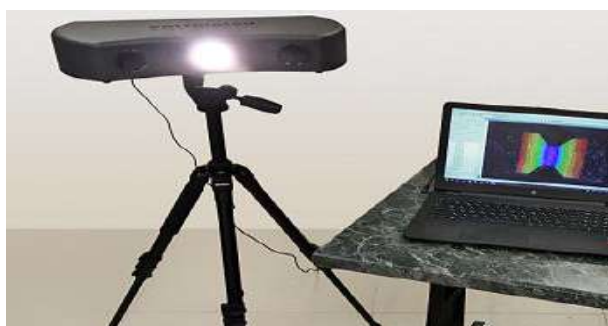
Рисунок 3.14 – Бесконтактная трехмерная система VIC-3D 8 для измерения деформации в полевых условиях Рисунок 3.15 – Результаты Vic-3D HS контроля
