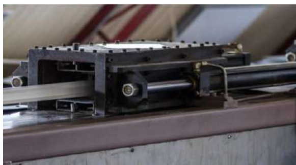
Рисунок 2.19 – Возвратно-поступательный механизм протягивания продольной арматуры
