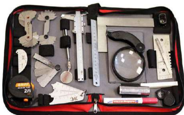
Рис.3.3 Универсальный комплект для визуального и измерительного метода контроля, применяемый для измерений на всех этапах производства пластмассовых изделий.
