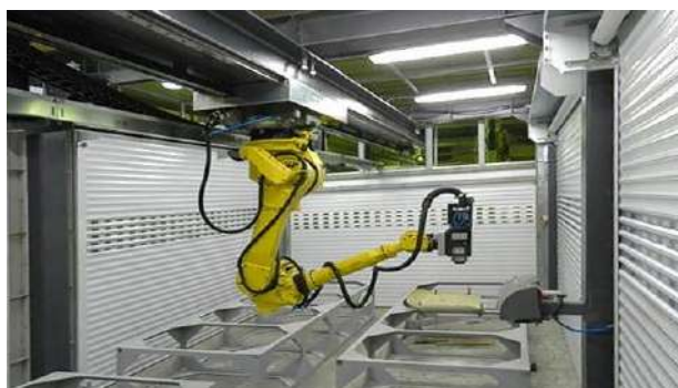
Рисунок 2.26 – Быстро перенастраиваемый робототехнический комплекс обработки изделий из пластика и стеклопластика
