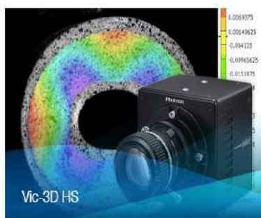
Рисунок 3.13 – Метод Vic-3D HS обнаружения деформации
