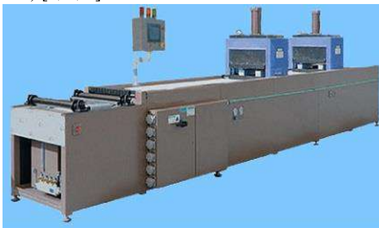
Рисунок 2.17 – Агрегат для формования методом пултрузии
