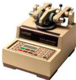
Рисунок 6.25 – Прибор Taber Abraser
