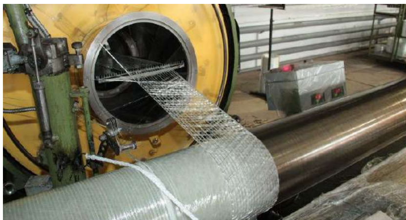
Рисунок 2.16 – Процесс изготовления труб методом намотки
