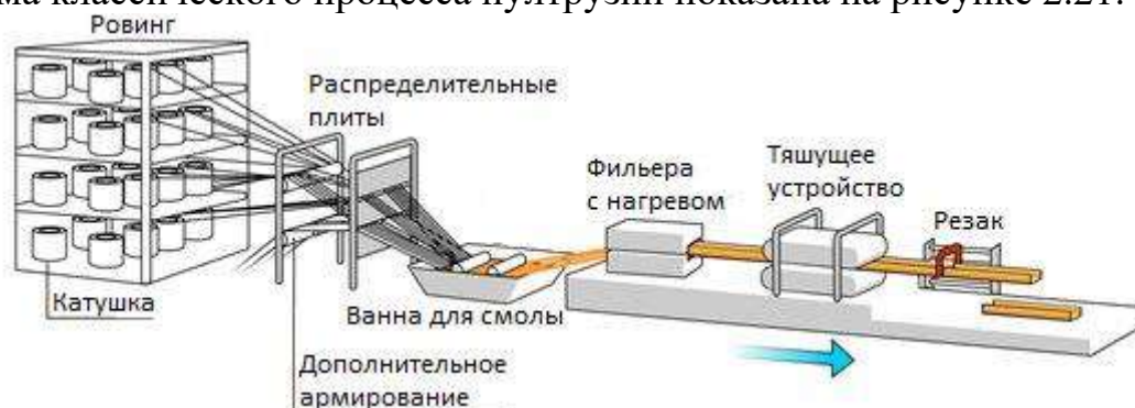
Рисунок 2.21 – Схема процесса пултрузии
