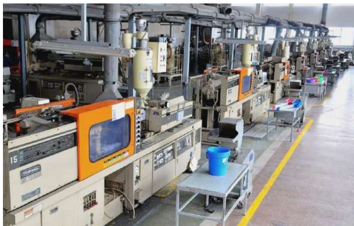
Рисунок 1.6 – Производственная линия термопластавтоматов цеха по производству изделий формованием
