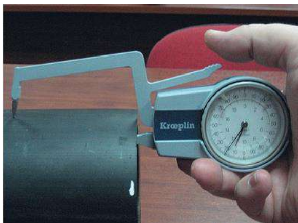
Рисунок 2 - Измерение толщины стенки
