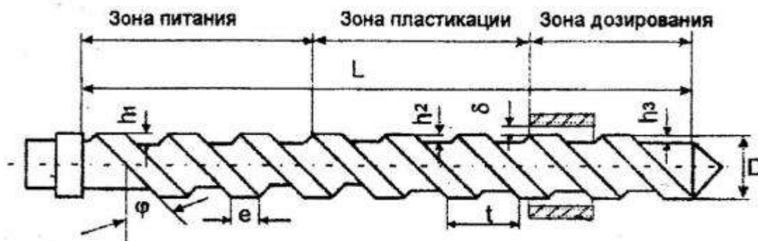
Рисунок 1.5 - Шнек экструдера
