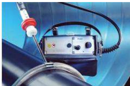
Рисунок 3.9 – Капиллярное бескамерное течеискание
