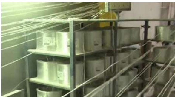
Рисунок 2.18 – Шпулярник полочного типа с системой предварительного натяжения продольной арматуры
