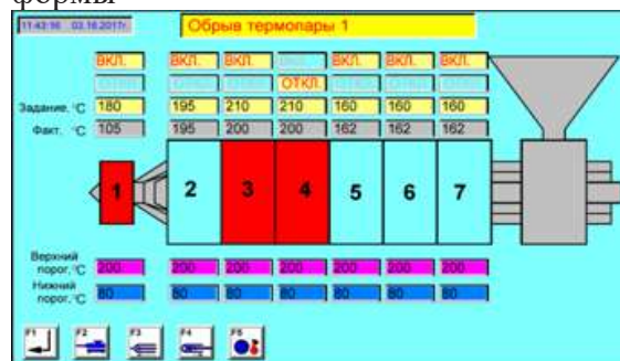
Мнемокадр 3. Нагревы материального цилиндра
