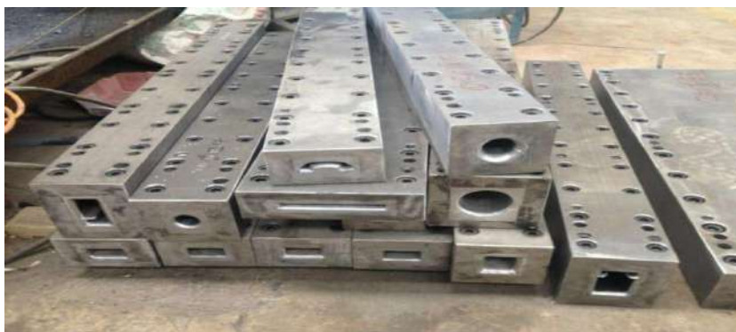
Рисунок 2.25- Фильеры для пултрузионной линии
