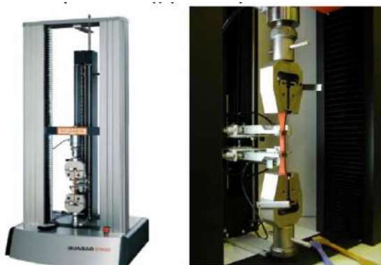
Рисунок 6.20 – Универсальная машина для проведения испытания на растяжение и узел машины для зажима образца
