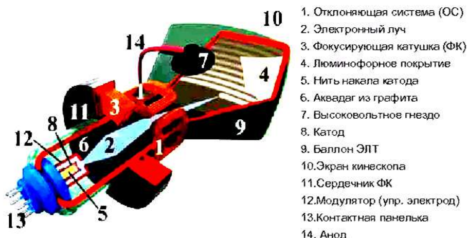
Рисунок 4.5 – Устройство черно-белого кинескопа на основе ЭЛТ
