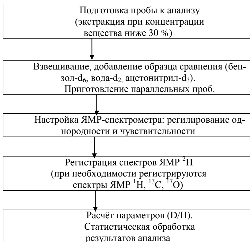
Рис. 4.3. Блок-схема определения природного содержания дейтерия методом спектроскопии ЯМР
