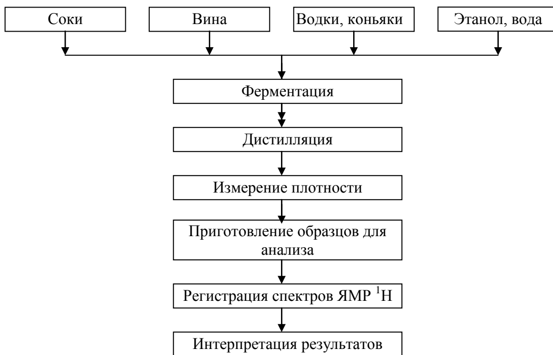
Рис. 4.4. Общая схема анализа соков и алкогольных напитков методом спектроскопии ЯМР 2 H
