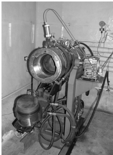
Рис. 5.33. Реактор СВС объемом 30 л
