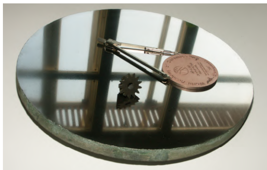
Рис. 6.32. Заготовка (диаметр – 360 мм, высота – 20 мм, масса – 10 кг)
