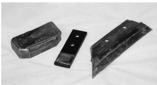
Рис. 7.45. Детали из стали с СВС-наплавкой: лопатка смесителя, долото и лемех почвообрабатывающего механизма
