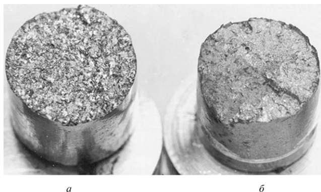
Рис. 8.4. Вид изломов экспериментальных образцов исходной стали (а) и с добавкой нанодисперсного порошка TiC (б) после испытаний на прочность при растяжении
