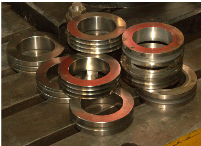
Рис. 6.37. Полупромышленная партия валков для горячей непрерывной прокатки меди на установке фирмы «Саутвайр» из сплава СТИМ-4 (12-я двухвалковая клеть)
