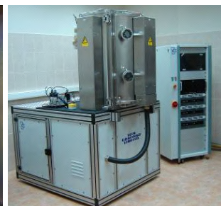
Рис. 6.26. Дисковые ( а ) и планарные ( б ) СВС-мишени, а также промышленные установки для магнетронного напыления ( в ), оснащенные мишенями, для нанесения функциональных наноструктурных пленок и покрытий
