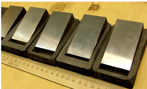
Рис. 6.42. Заготовки для лопаток турбин из сплава 48\text{Ti}-48\text{Al}-2\text{Nb}-2\text{Cr}
