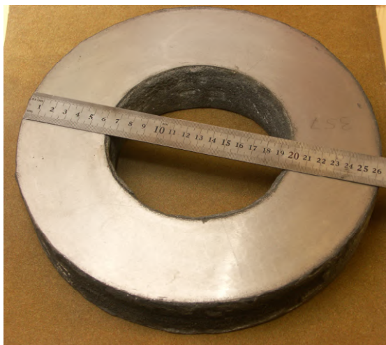
Рис. 6.35. Заготовка вытяжного штампа из сплава СТИМ-4 (наружным диаметр – 260 мм, внутренний диаметр – 135 мм, высота – 50 мм)
