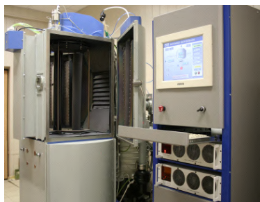
Рис. 6.26. Дисковые ( а ) и планарные ( б ) СВС-мишени, а также промышленные установки для магнетронного напыления ( в ), оснащенные мишенями, для нанесения функциональных наноструктурных пленок и покрытий
