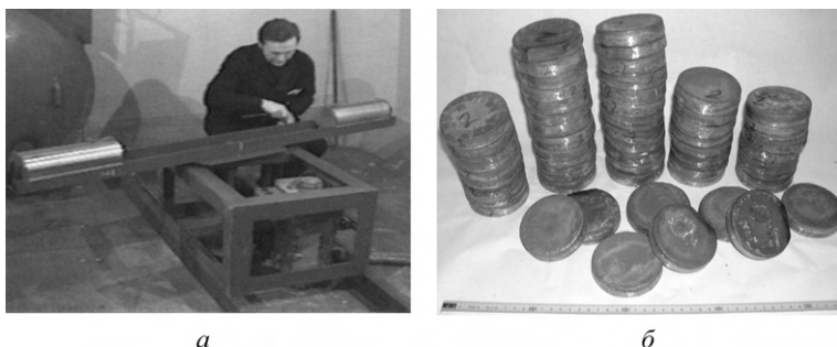
Рис. 7.40. Опытная центробежная СВС-установка (а) для изготовления литых жаропрочных сплавов (б). Масса исходной смеси – 1...10 кг, масса слитка – 0,5...6,0 кг
