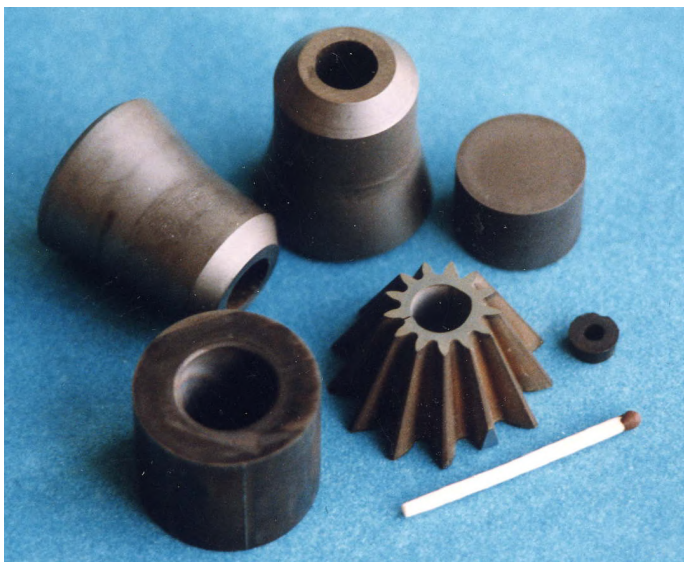
Рис. 6.40. Изделия сложной геометрической формы из компактных СВС-материалов, полученные методом электроэрозионной обработки
