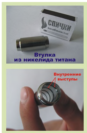
Рис. 4.4. Втулка для соединения труб гидравлической системы военных самолетов
