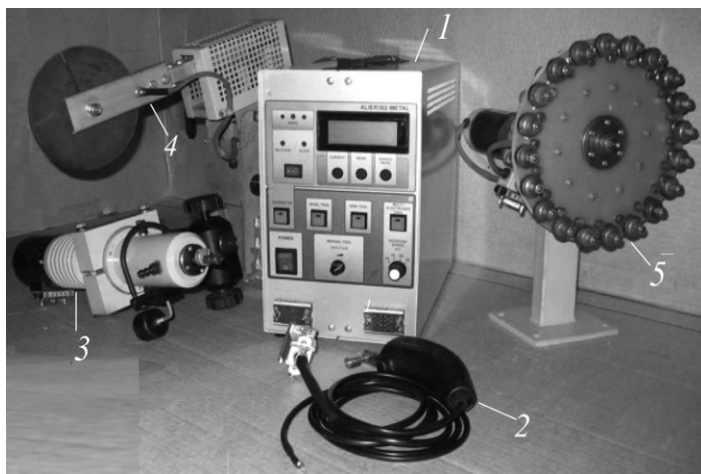
Рис. 6.27. Установка для электроискрового упрочнения ALIER-303 METAL с микропроцессорным управлением: 1 – генератор; 2 – инструмент для ручной обработки; 3 – инструмент осевой для механизированной обработки; 4 – инструмент для закрепления дискового электрода при механизированной обработке; 5 – инструмент многоэлектродный для механизированной обработки
