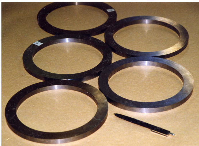
Рис. 6.36. Твердосплавные кольца размером \varnothing 218 \times \varnothing 140 \times 8 мм для бисерной мельницы фирмы «Драйс» (работают в паре, вращаясь относительно друг друга со скоростью 820 об/мин; служат для фильтрации твердых частиц размером 0,3 мм в процессе приготовления красок)
