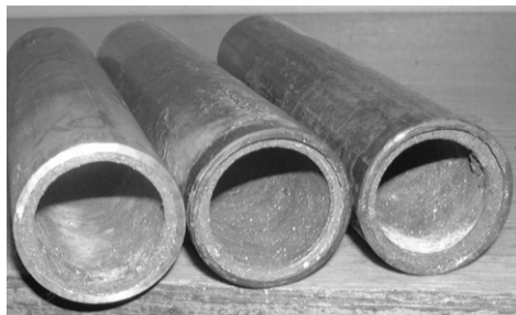
Рис. 7.47. Трубы с внутренними покрытиями из литого корунда (исходные реагенты – отходы металлообработки)
