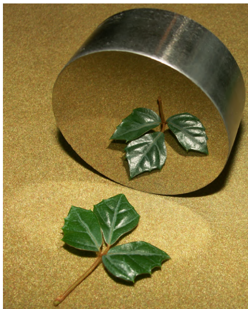
Рис. 6.38. Подкладная плита из сплава TiC–Ni–Mo оснастки для получения искусственных алмазов (диаметр – 75 мм, высота – 20 мм, масса – 0,85 кг, твердость – 90 HRA, пористость – 0,2 %, предел прочности при изгибе – 1000 МПа)
