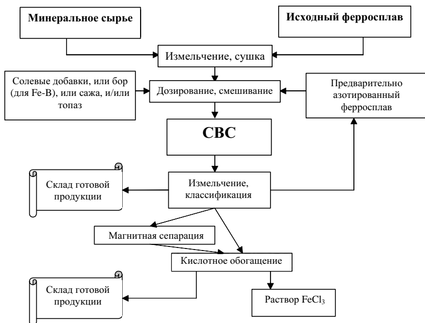
Рис. 5.28. Схема получения нитридсодержащих порошков, композиционной керамики и технологии с использованием нитридсодержащих продуктов СВС
