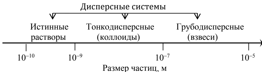
Рис. 3.4. Деление дисперсных систем по размерам частиц дисперсной фазы
