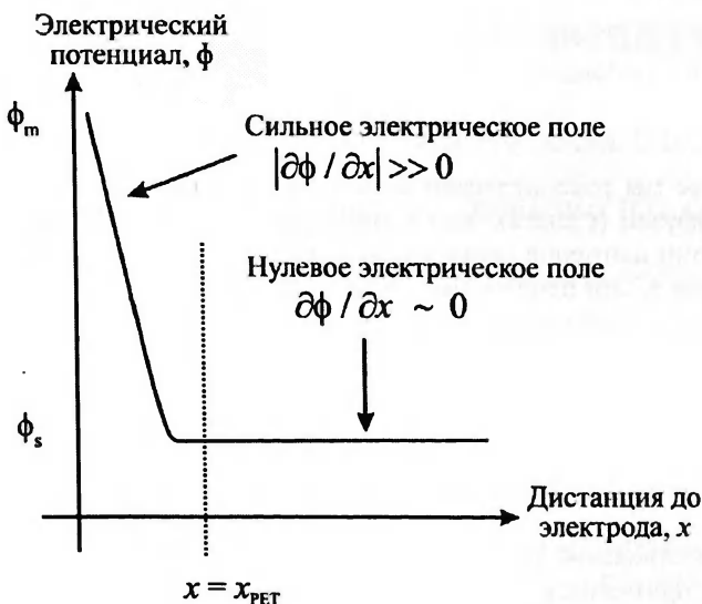
Рис. 10.1. Распределение потенциала для вольтамперометрии «с фоном», где расстояние для перехода электрона x_{\text{PET}} \approx 10 – 20 Å
