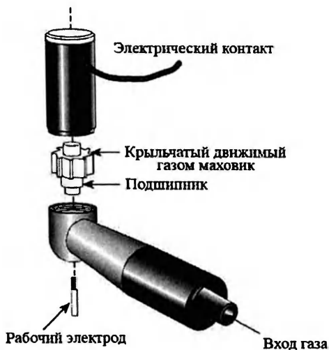
Рис. 8.4. Схематическое представление высокоскоростного вращающегося электрода, приводимого в движение давлением газа [1]
