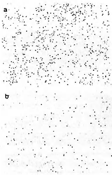
Рис. 9.8. Микроскопические снимки осадка свинца из раствора, содержащего 5\text{мМ Pb}(\text{NO}_3)_2/0.1\text{ М HNO}_3 на (А) допированном бором алмазном электроде и (В) стеклогуглеродном электроде, показывающие в каждом случае (а) область наибольшей плотности осаждения и (б) область наименьшей плотности осаждения (см. текст). Условия осаждения: -0.48\text{ В} (отн. нас. КЭ) за 60\text{ с} . Общая площадь изображения 540 \times 400\text{ мкм} [5]
