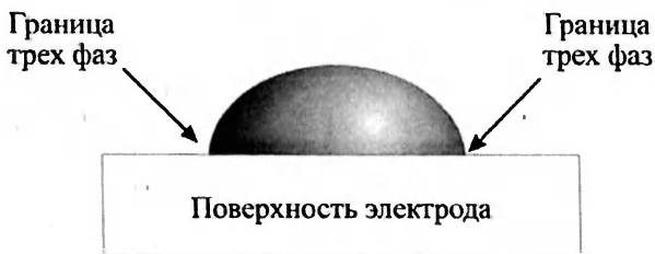
Рис. 7.32. Схема капли, нанесенной на поверхность электрода
