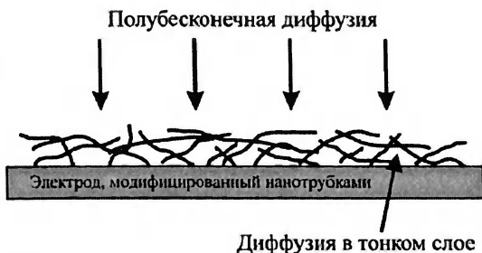
Рис. 6.29. Схема двух типов диффузии, которые вносят вклад в ток на электроде, модифицированном нанотрубками [15]
