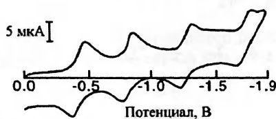
Рис. 4.17(А). Циклическая вольтамперограмма C_{60}
