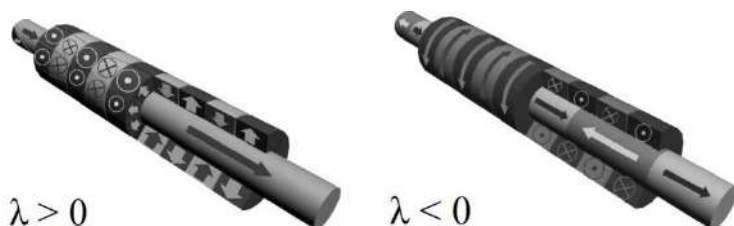
Рис. 31. Модели доменной структуры микропроводов с положительной (а) и отрицательной (б) константами \lambda магнитострикции, стрелки указывают направление намагниченности доменов
