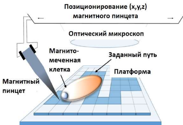
Рис. 24. Схема манипулирования магнитомечеными клетками с помощью магнитного пинцета
