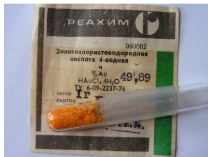
Рис. 3.23. \text{H}[\text{AuCl}_4] в растворе и выделенная 9
