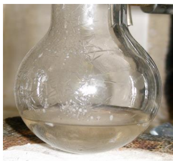
Рис. 9.24. Гидросульфат калия \text{KHSO}_4 , выросший на стенках колбы для получения хлороводорода
