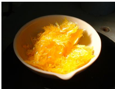
Рис. 3.21. \text{K}[\text{ICl}_4] : иголки и пластинки
