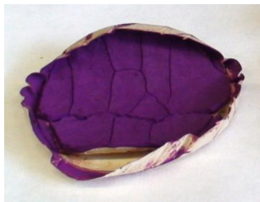
Рис. 6.12. Сохнувший осадок перманганата трифенилтетразоля на фильтре и строение катиона трифенилтетразоля
