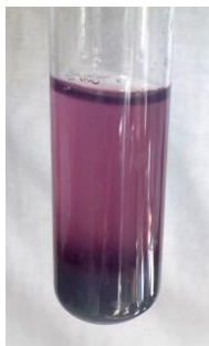
Рис. 6.8. [Cr(NH_3)_6]^{3+} (на дне пробирки – не полностью растворившийся гидроксид хрома)
