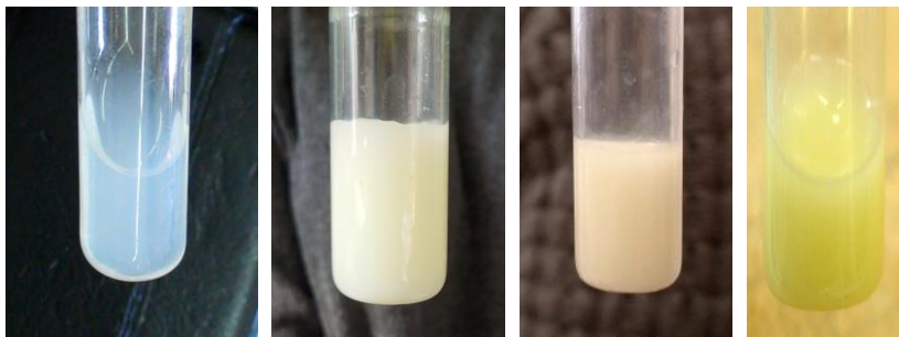
Рис. 3.4. Выделяющаяся сера на разных последовательных этапах разложения H_2S_2O_3 (слева направо)
