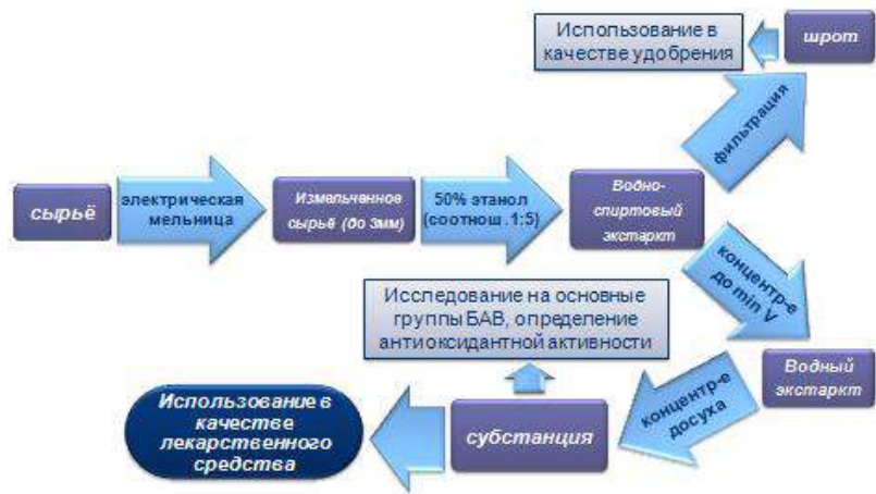
Рис. 63. Технологическая схема получения субстанции из корней кермека тысячцветкового
