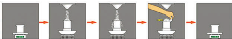
Рис. 12. Определение насыпной (объемной) плотности
