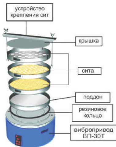
Рис. 8. Современный модель ситового анализатора вращательно-встряхивающим действием
