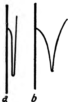
Рис. 60. Двойная металлическая пластинка для терморегулятора.
