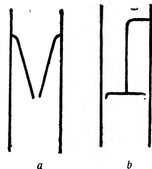
Рис. 315. Простые сепараторы пара.
