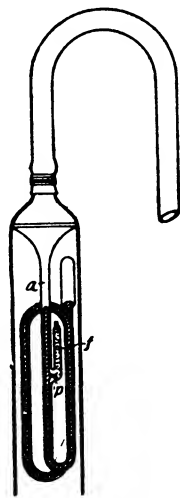
Рис. 73. Вентиль для впуска воздуха.
