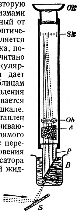
Рис. 611. «Погруженный» рефрактометр Цейсса.
