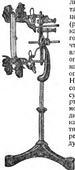
Рис. 584. Ртутно-кварцевая горелка Гереуса.
