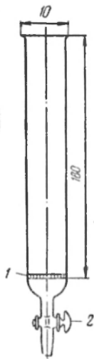
Рис. 42. Хроматографическая колонка для разделения смесей веществ: 1 — пористая перегородка; 2 — кран
