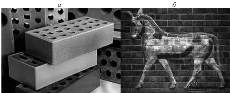
Рис. 3.13. Образцы глазурованного кирпича ( а ), мозаичное панно из глазурованного кирпича на фрагменте фасада ( б )
