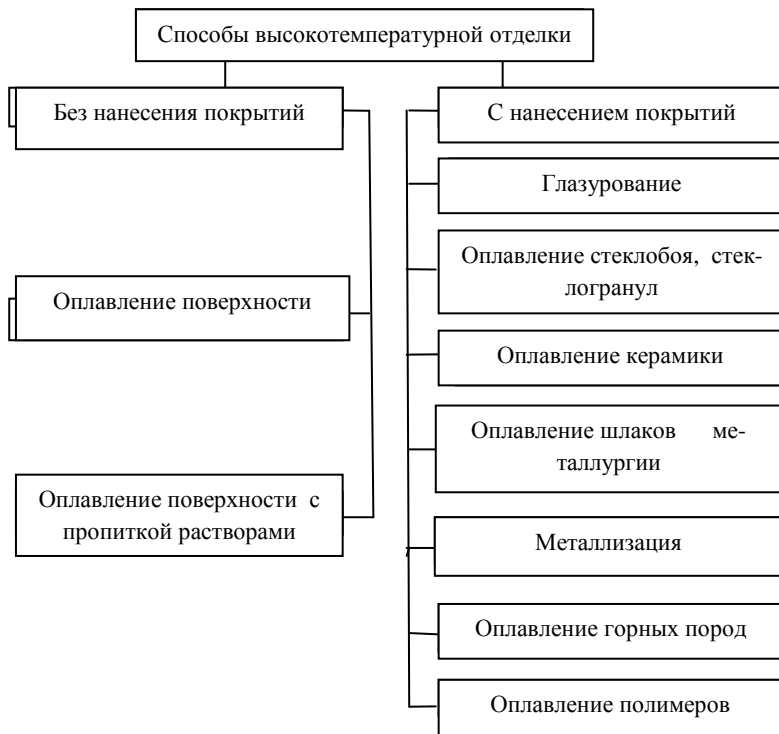
Рис. 5.1. Классификация способов высокотемпературной отделки бетонных (железобетонных) изделий
