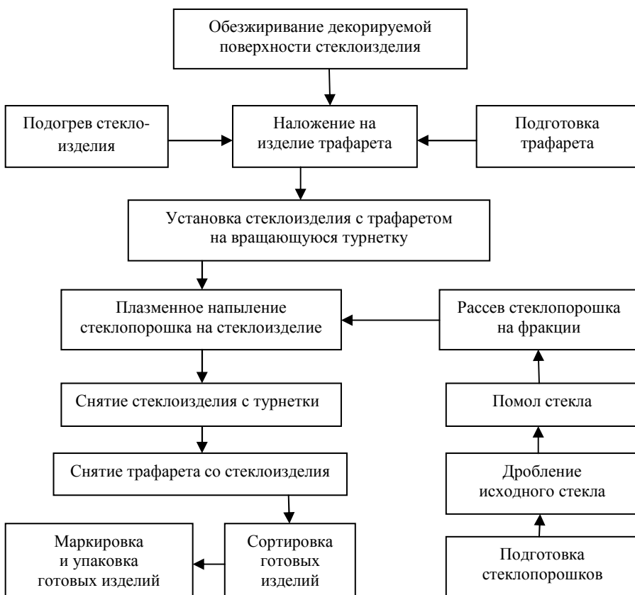
Рис. 4.5. Общая технологическая схема декорирования стеклоизделий методом плазменного напыления
