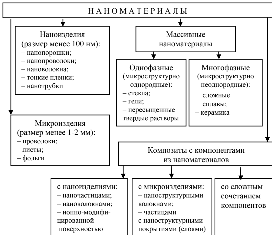
Рис. 1.1. Основные категории наноматериалов
