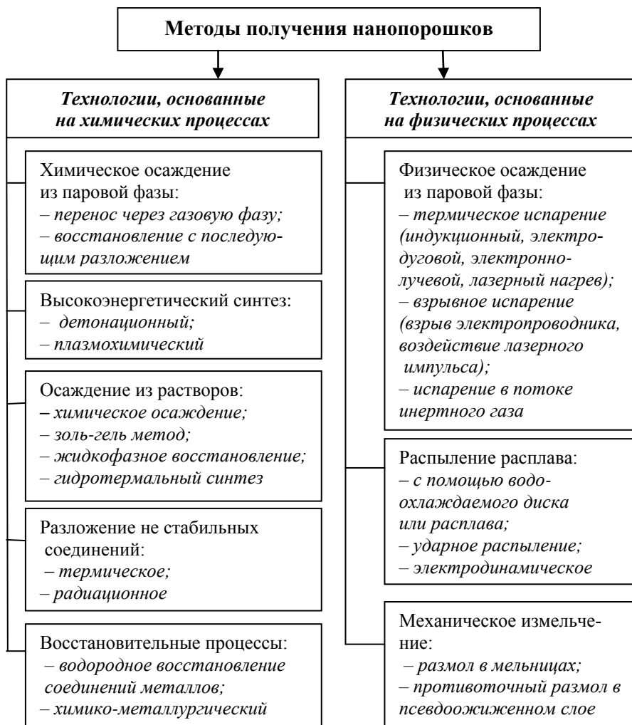
Рис. 1.11. Основные методы получения нанопорошков
