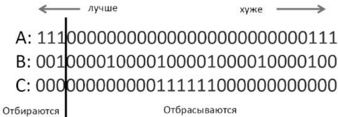
Рис. 74. Проблема «раннего распознавания»: три ранжирующих фильтра А, В, С, которые характеризуются одинаковыми значениями метрик «среднего распознавания», приводят к разному числу отбираемых активных соединений.
