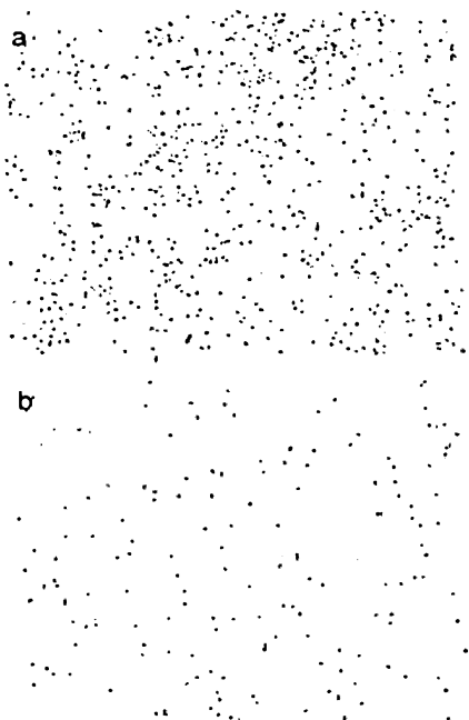
Рис. 9.8. Микроскопические снимки осадка свинца из раствора, содержащего 5мМ \text{Pb}(\text{NO}_3)_2/0.1 \text{ M HNO}_3 на (А) допированном бором алмазном электроде и (В) стеклоуглеродном электроде, показывающие в каждом случае (а) область наибольшей плотности осаждения и (b) область наименьшей плотности осаждения (см. текст). Условия осаждения: -0.48 \text{ В} (отн. нас. КЭ) за 60 с. Общая площадь изображения 540 \times 400 \text{ мкм} [5]
