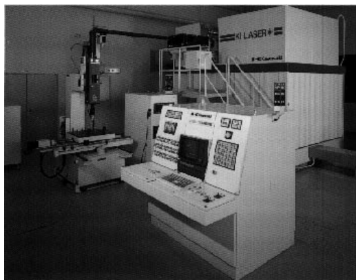
Рис.8. Промышленный КИЛ фирмы «Кавасаки» мощностью 1 кВт.
