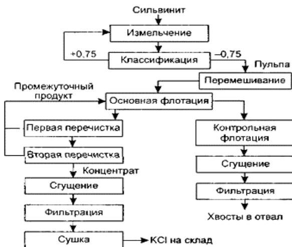
Рис. 22. Принципиальная схема флотации калийных руд с депрессией глинистого шлама
