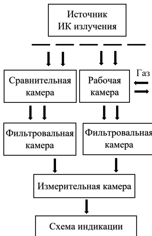
Рис. 15. Схема автоматического проточного газоанализатора
